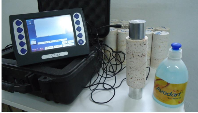
Şekil 2: Kayaçların P dalga hızını belirlemek için kullanılan MATEST sonik cihazı
