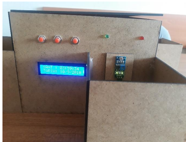
Şekil 7: LCD Ekran ve Ayar Butonlarının İlaç Kutusundaki Yerleşimi
