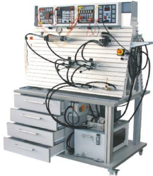
Şekil 1. Örnek Hidrolik Eğitim Seti, Ogen Oransal Hidrolik Seti
